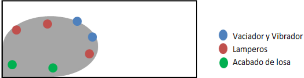
Figura #62 Procedimiento de Vaciado de Losas observado en el análisis de la partida (Fuente Propia)
