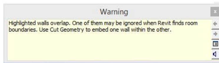
FIGURA 44. DIÁLOGO DE ERROR POR ELEMENTOS SOLAPADO. DETECCIÓN DE INTERFERENCIA
