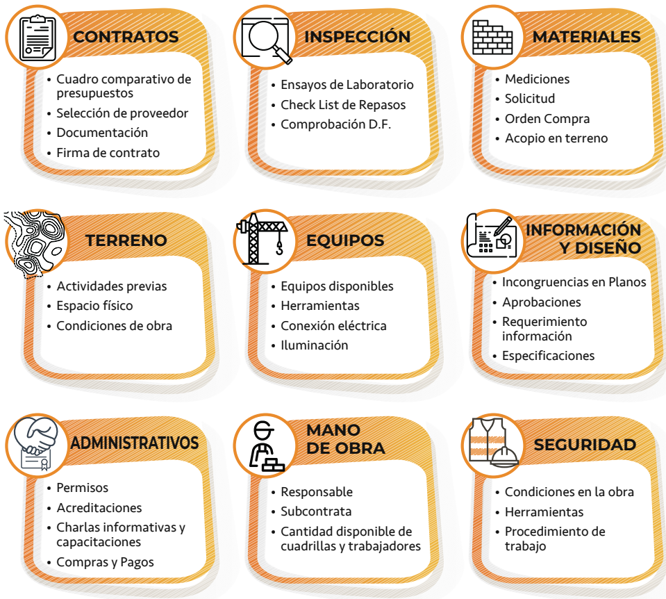
Figura 28. Principales áreas o categorías de donde podemos identificar restricciones para generar Inventario de Trabajo Ejecutable (ITE).
